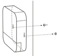
3. Hängen Sie die Außensirene mit Blinklicht in die mittleren zwei Löcher Vorrichtungen.
