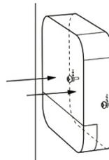
4. Drücken Sie die Außensirene mit Blinklicht nach unten. Dadurch werden die Schrauben in den beiden Löchern der Außensirene mit Blinklicht befestigt.
