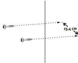
2. Ziehen Sie die Schrauben genau bis zum Ende des Gewindes in der Wand an.
